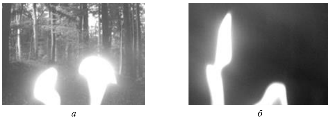
Рис. 4.18. Изображения пламени на фоне дневного леса, полученные с использованием светофильтров: а – СЗС-17 с синей границей 0,5 мкм; б – КС-19 с синей границей 0,75 мкм
