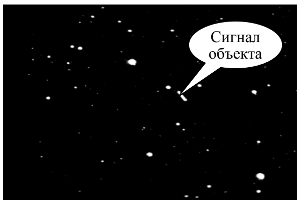
Рис. 2.11. Изображение экрана монитора телевизионной системы контроля космического пространства с сигналом от движущегося спутника на фоне звёзд; смаз на порядок больше размера объекта
