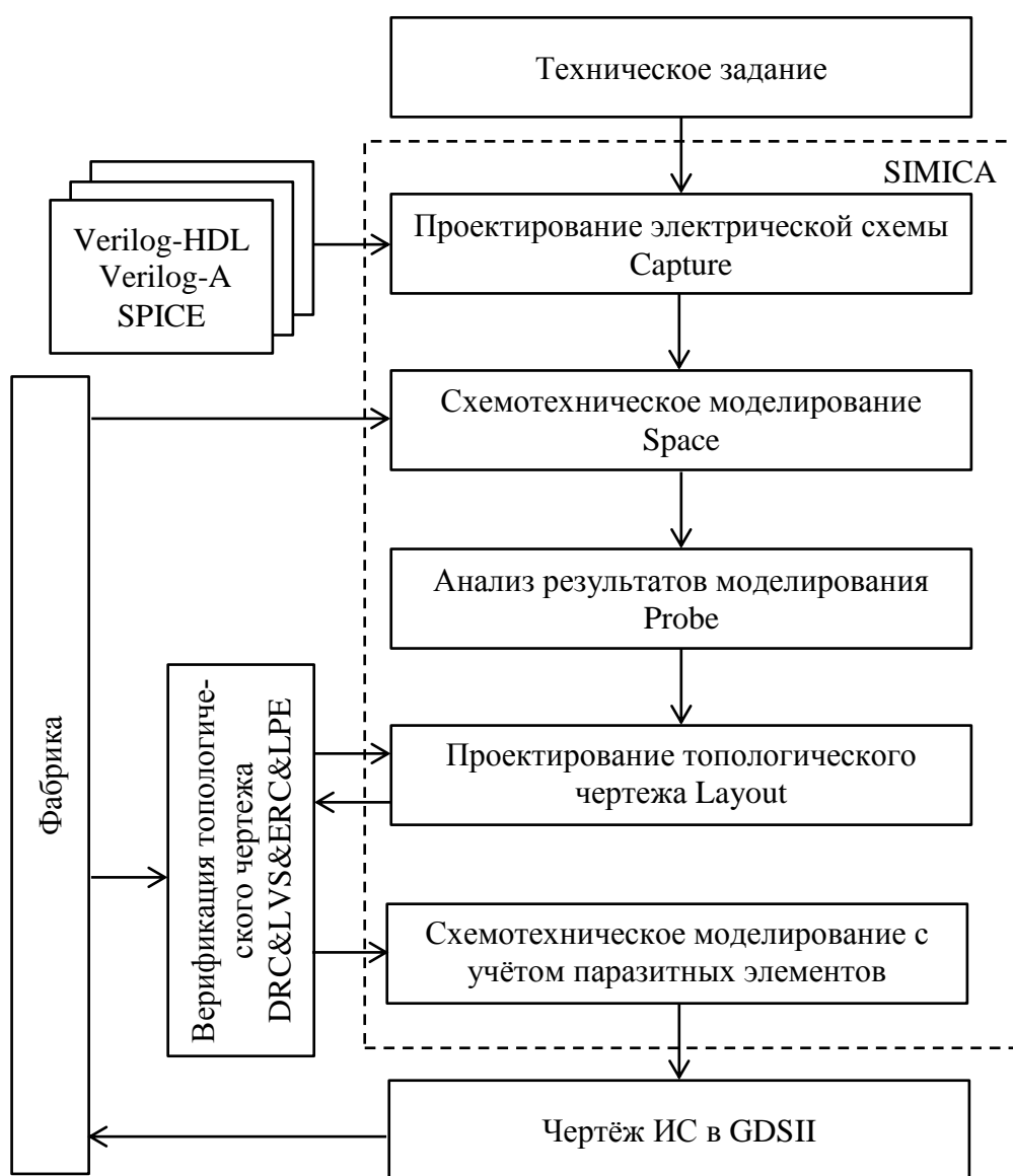
Рис. 3.12. Маршрут проектирования цифроаналоговых ИС в САПР SIMICA
